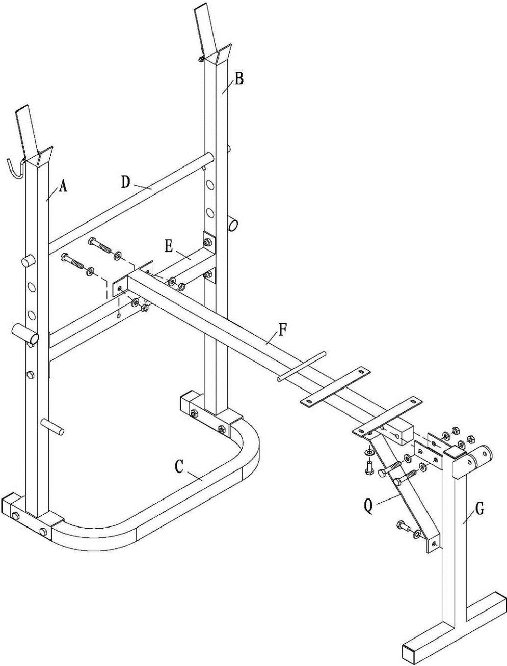
Befestigen Sie die Hauptstange (F) am Querträger (E) mit Schrauben M10x60, wie auf dem Bild gezeigt wird. Dann befestigen Sie die vordere Stange (G) an der Hauptstange (F) mit Schrauben M10x60, wie auf dem Bild gezeigt wird.
