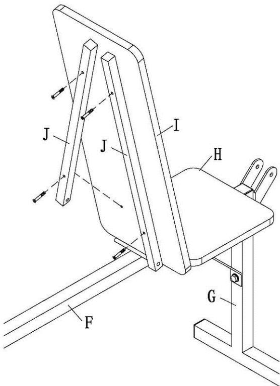
Připevněte 2 čtvercové podpěry (J) k hlavní tyči (F). Připevněte opěrku zad (I) k čtvercovým podpěrám (J) pomocí šroubů M6x40.
