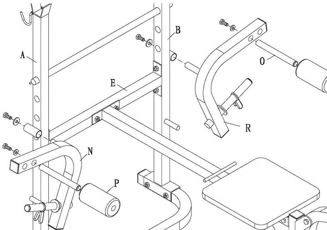
Przymocuj obydwa ramiona motylka (N, R) do pionowych wsporników, jak przedstawiono na obrazku za pomocą śrub M10x25. Śruby powkładaj do nylonowych podkładek i następnie do wspornika, dokręć.
