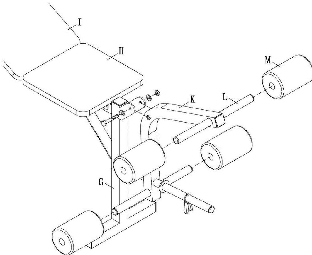
Befestigen Sie die Fußstange (K) an der vorderen Stange (G) mit Schraube M10x65, wie auf dem Bild gezeigt wird. Diese Stange ziehen sie richtig fest, aber so, dass sie sich fließend bewegen kann. Setzen Sie die Stange (L) in die entsprechende Position (abhängig von der Größe des Turners), schieben Sie die Ring-Schaumstoffe (M) an allen Enden der Stangen.
