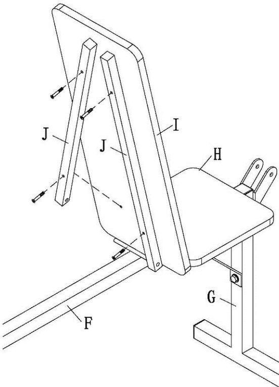
Befestigen Sie 2 Quadratstützen (J) an der Hauptstange (F). Befestigen Sie die Rückenstütze (I) an den Quadratstützen (J) mit Schrauben M6x40.
