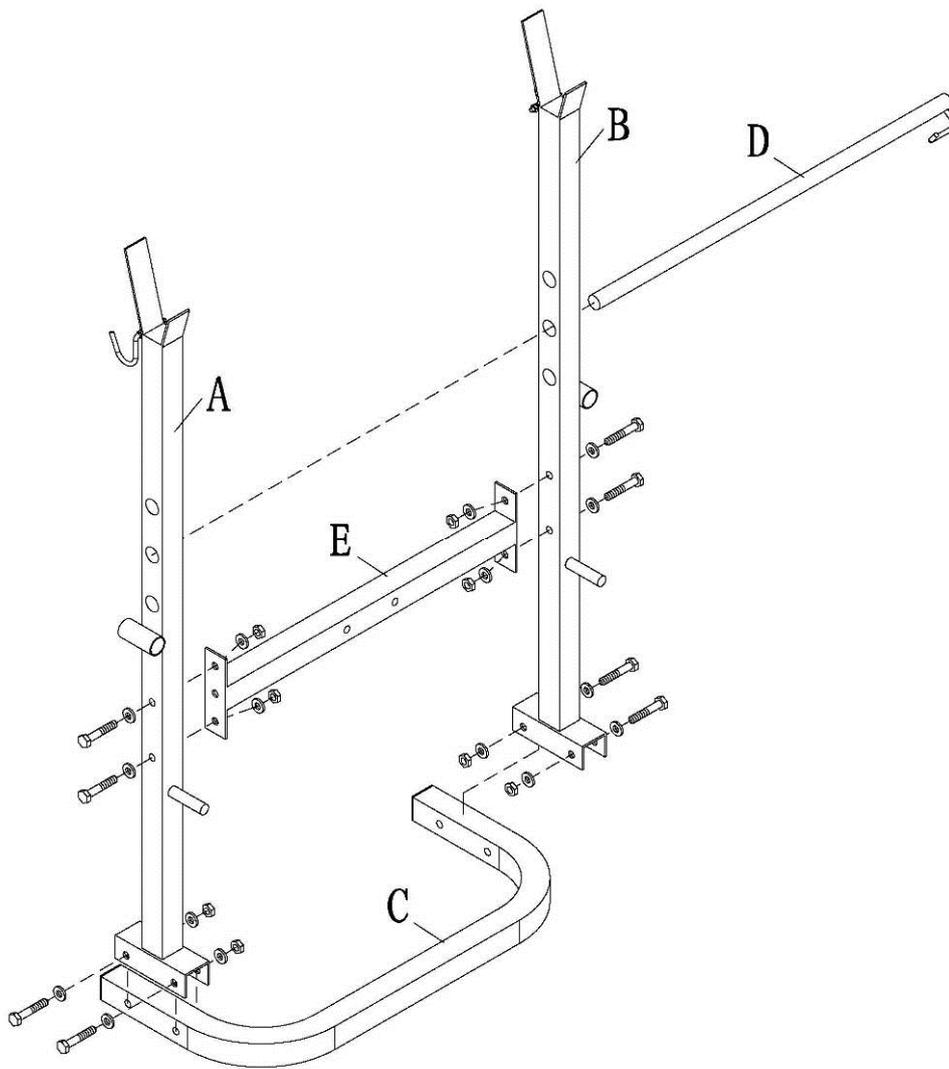
Przymocuj obydwie wsporniki (A,B) do dolnego drążka (C) za pomocą śrub M10x60, jak przedstawiono na obrazku. Następnie przymocuj poprzeczkę (E) do obydwu wsporników(A,B) za pomocą śrub M10x60. Włóż wspornik do regulacji (D) przez obydwie pionowe wsporniki (A,B).
