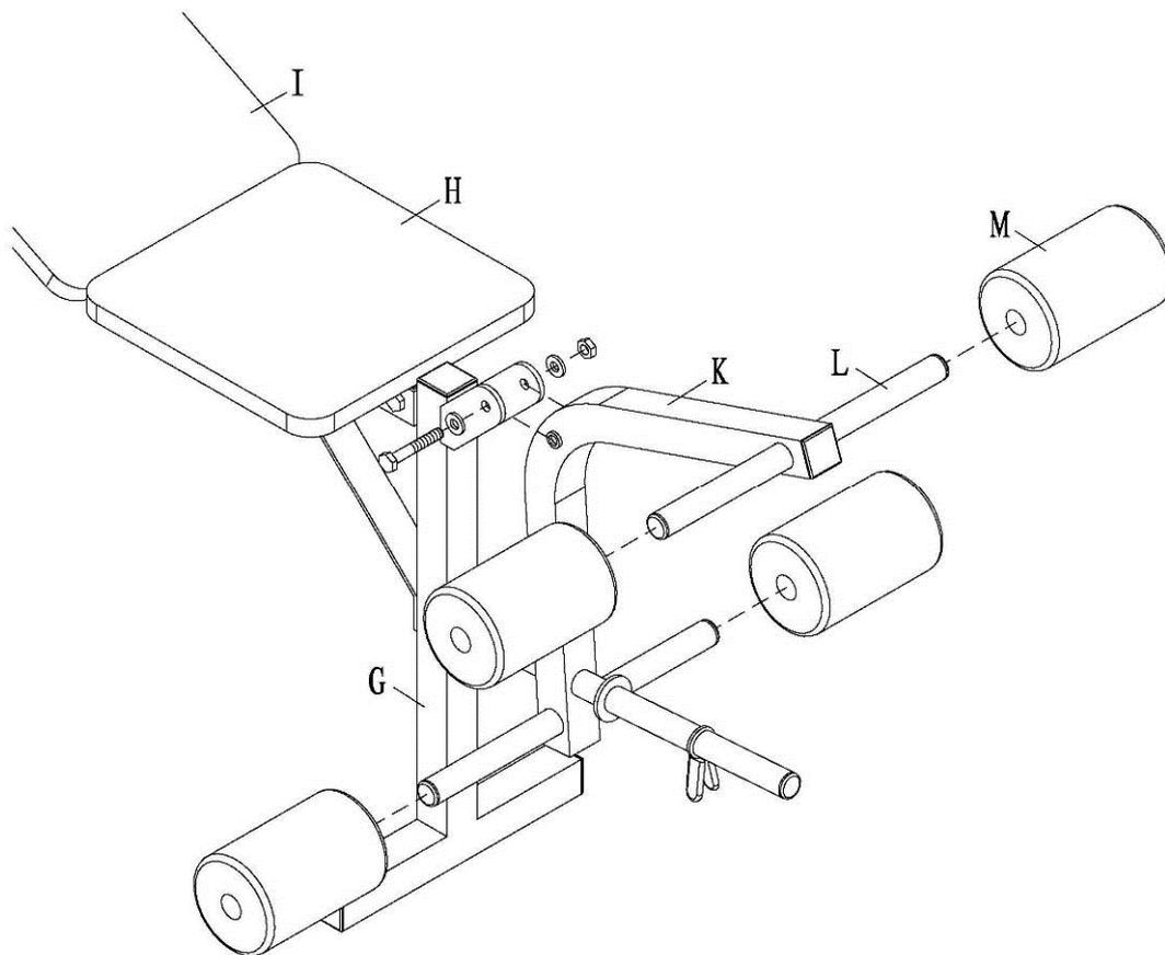
Pripevnite nožnú tyč (K) k prednej tyči (G) pomocou skrutky M10x65, ako na obrázku. Túto tyč dotiahnite poriadne, ale tak, aby sa mohla pohybovať, aby nešla ťažko.
