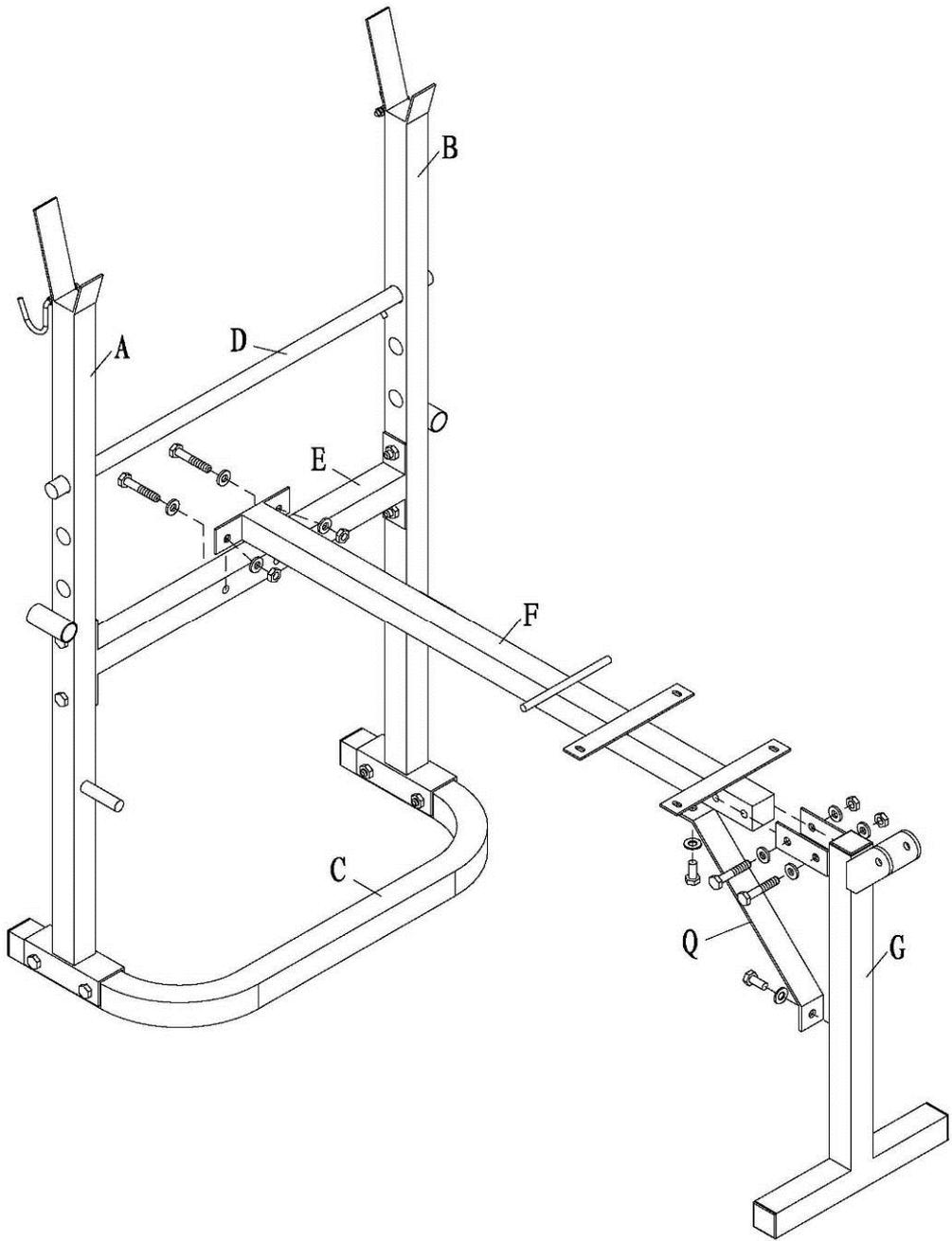
Pripevnite hlavnú tyč (F) ku krížovej tyči (E) pomocou skrutiek M10x60, ako je ukázané na obrázku. Potom pripevnite prednú tyč (G) k hlavnej tyči (F) pomocou skrutiek M10x60, ako na obrázku. Pripevnite diagonálnu podperu (Q) k hlavnej tyči (F) a prednej tyči (G) pomocou skrutiek M8x16.
