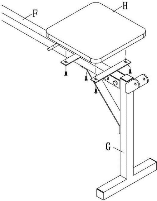
Stellen Sie den Sitz (H) auf die Basisstütze und versichern Sie sich, dass das breitere Sitzende zur Rücken richtet – wie auf dem Bild gezeigt wird. Ziehen Sie den Sitz mit Schrauben M6x16 fest.
