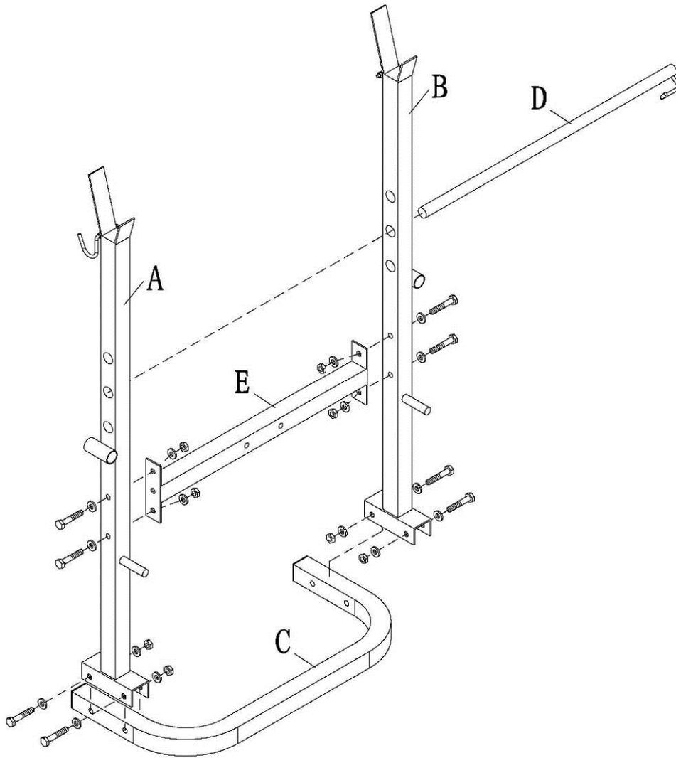
Befestigen Sie beide Stangen (A, B) an der unteren Stange (C) mit Schrauben M10x60, wie auf dem Bild gezeigt wird. Dann befestigen Sie den Querträger (E) an beiden Stangen (A, B) mit Schrauben M10x60. Setzen Sie die Einstellstange (D) über die beiden vertikalen Stangen (A, B).
