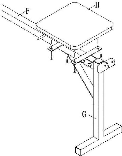
Umieść siodło (H) na podporze i upewnij się, że szersza końcówka siodła jest skierowana do tyłu – jak przedstawiona na obrazku. Zamocuj siodło za pomocą śrub M6x16.
