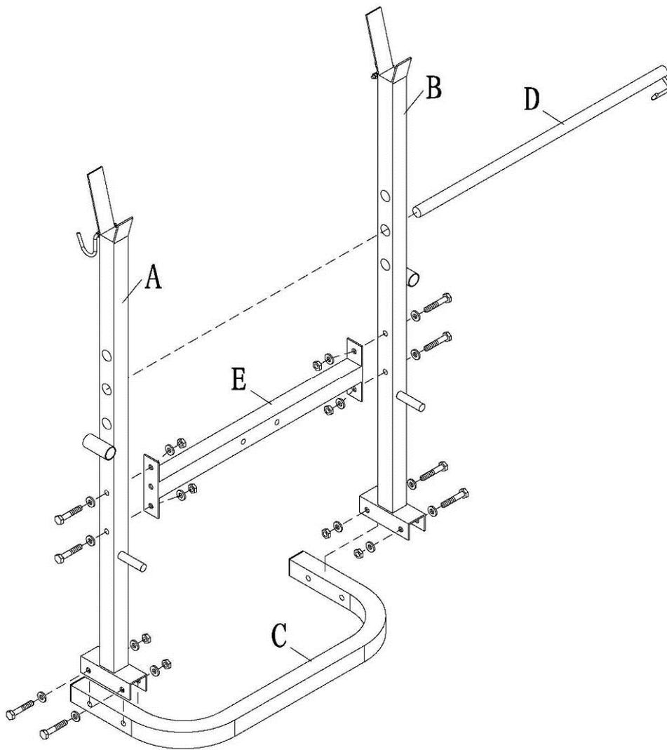
Pripevnite obe tyče (A, B) k spodnej tyči (C) pomocou skrutiek M10x60, ako je zobrazené na obrázku. Potom pripevnite krížovú tyč (E) k oboj tyčiam (A, B) pomocou skrutiek M10x60. Vložte nastavovaciu tyč (D) cez obe zvislé tyče (A, B).
