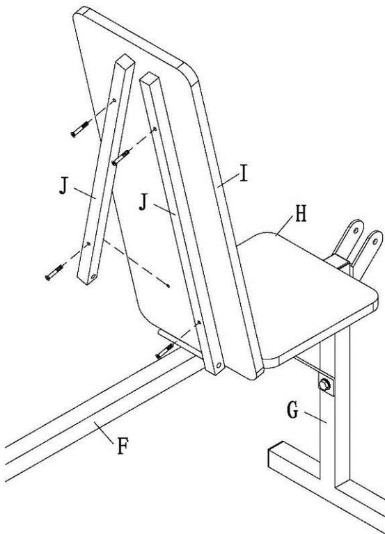
Przymocuj 2 prostokątne wsporniki (J) do głównego wspornika (F). Przymocuj oparcie (I) do prostokątnych podpór (J) za pomocą śrub M6x40.
