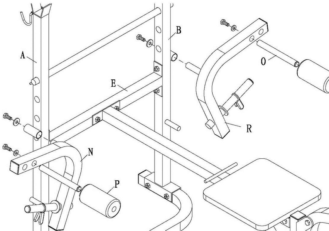
Pripevnite obe ramená butterfly (N, R) k zvislým tyčiam, ako na obrázku pomocou skrutiek M10x25. Skrutku dajte najskôr do nylonovej vložky a až potom do tyče, potom dotiahnite.
