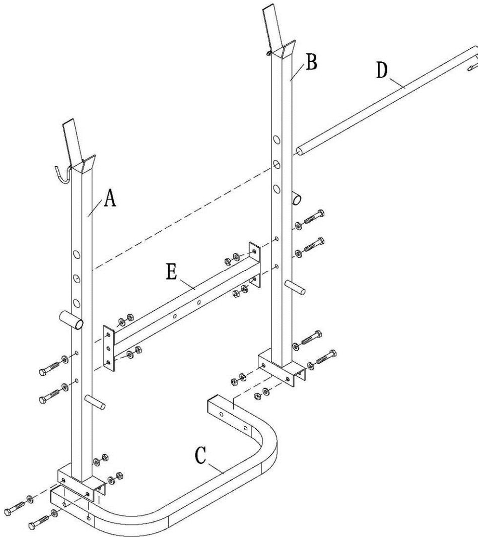
Připevněte obě tyče (A,B) ke spodní tyči (C) pomocí šroubů M10x60, jak je ukázáno na obrázku. Pak připevněte křížovou tyč (E) k oběma tyčím (A,B) pomocí šroubů M10x60.
